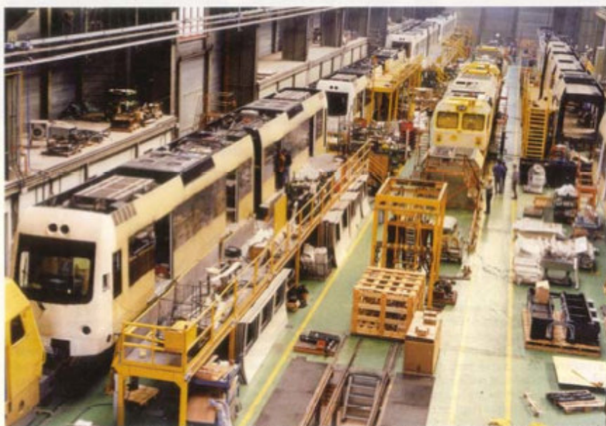
Línea de montaje de trenes de Vossloh, cuyas locomotoras van a parar a compañías como Renfe.
